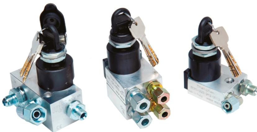
**MLS W 020 È L'ANTIFURTO ELETTROMECCANICO CHE AGISCE SULL'IDRAULICA DEL MEZZO SENZA ALTERARNE LE FUNZIONI ORIGINALI. PERMETTE DI OTTENERE IL BLOCCO TOTALE DEL VEICOLO IMPEDENDONE OGNI SPOSTAMENTO E QUINDI IL FURTO.**
